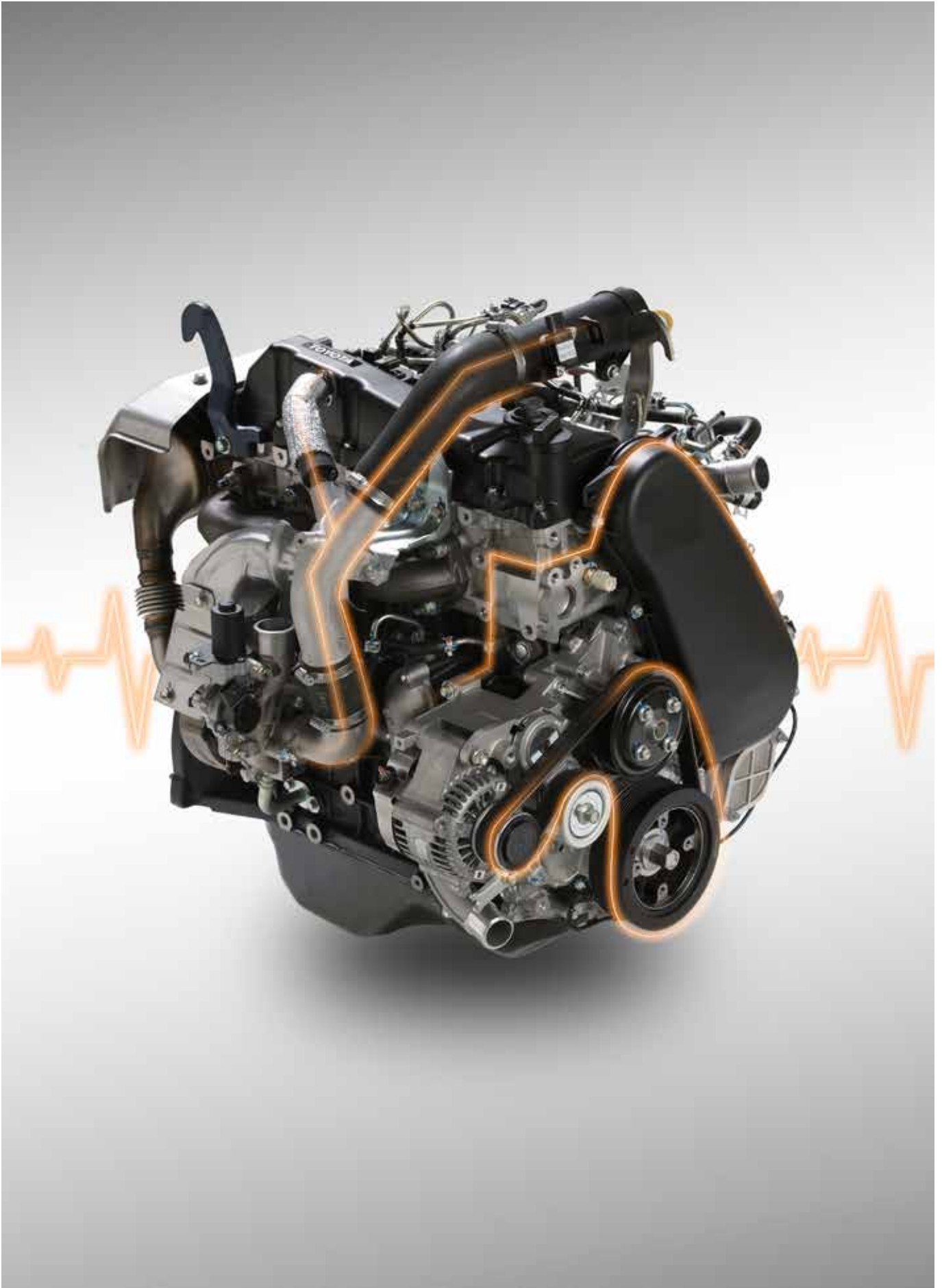
Motor Toyota 1KD diésel con common rail
