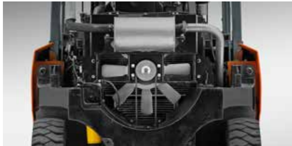
El ventilador, el radiador, el enfriador del convertidor de par integrado y el enfriador de aceite hidráulico impiden el sobrecalentamiento del motor. De este modo se obtiene un rendimiento máximo.
