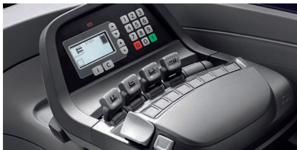
Las minipalancas estándar permiten el control de cada movimiento de las horquillas con la punta de los dedos
