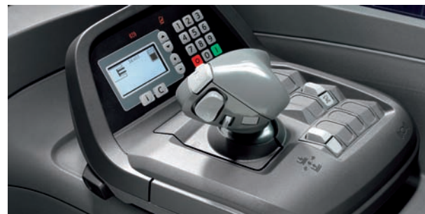
Se puede seleccionar una unidad de control multifunción opcional, dependiendo de las preferencias y la experiencia de los conductores
