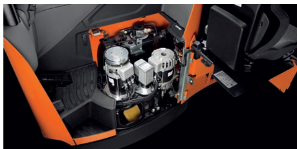
Las BT Reflex tienen la durabilidad incorporada al diseño con las unidades eléctricas selladas, los motores sin escobillas y los conectores a prueba de fugas
