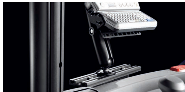
La barra E opcional se ha diseñado para llevar equipo auxiliar, ofreciendo conexiones estándar y una fuente de alimentación incorporada
