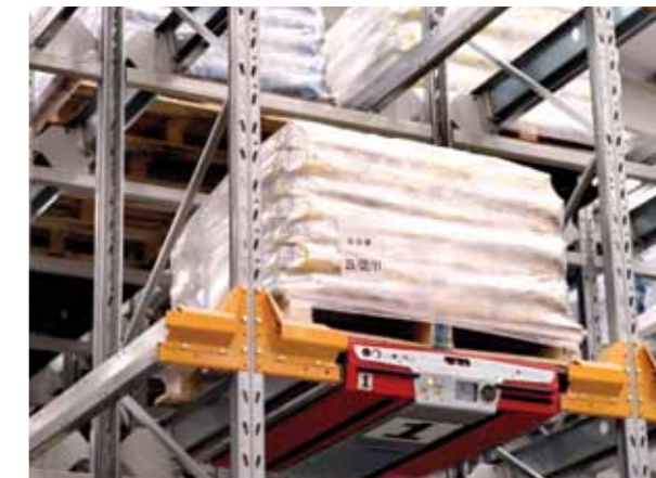
Las unidades BT Radioshuttle emiten señales visuales y acústicas cuando se mueven
