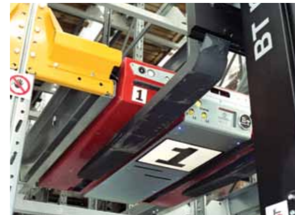
Las guías de horquilla garantizan una transferencia segura y precisa de las unidades de transporte utilizando carretillas elevadoras convencionales.
